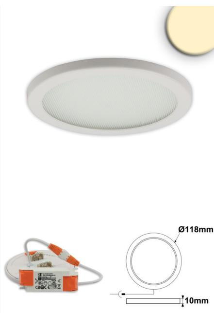
**Spécificités:** ultra-plat, incluant un transformateur externe enfichable de 280mA, tient dans une découpe de trou variable de min. 50mm à max. 100mm au moyen de clips à ressort réglables.
