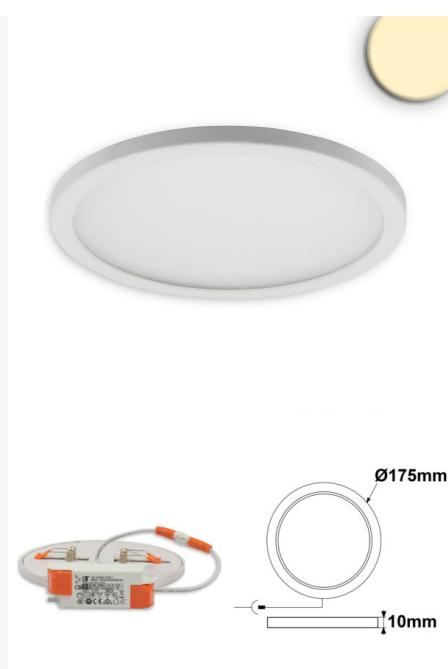
**Spécificités:** ultra-plat, avec transformateur externe enfichable de 280mA, se fixe au moyen de pinces à ressort réglables dans une découpe de trou variable de min. 50mm à max. 160mm
