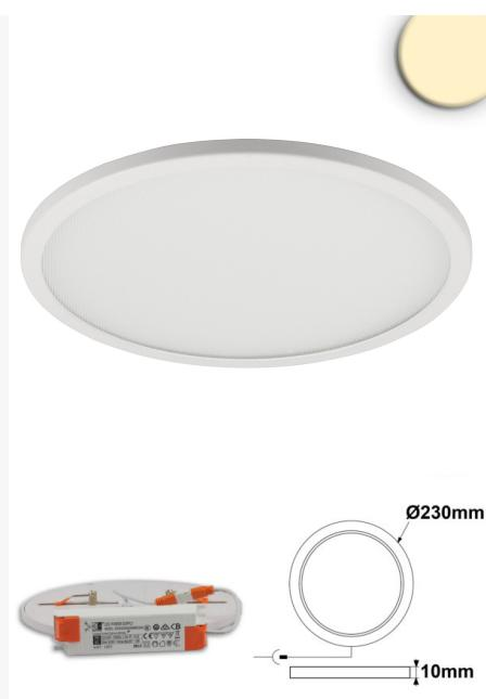
**Spécificités:** ultra-plat, avec transformateur externe enfichable de 600mA, se fixe au moyen de pinces à ressort réglables dans une découpe de trou variable de min. 50mm à max. 210mm
