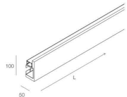
**Spécificités:** Profilé pour ruban LED en plaques de plâtre avec un angle d'inclinaison de 90 degrés. Pour une installation murale, peut être découpé lors de l'installation. S'intègre parfaitement au mur.
