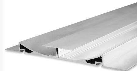
**Spécificités:** IMPORTANT: La surface adhésive doit être dégraissée avant utilisation! Le profilé doit être fixé tous les 40 cm afin d'éviter les risques de dilatation. La LED doit être collée sur une surface dégraissée délicatement sans être pliée. Le collage du ruban s'effectue toujours hors tension. Masse frigorifique = 1753 grammes/mètre, Conçu pour les bandes flexibles LED d'une largeur maximale de 11 mm.
