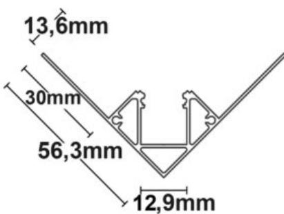
**Spécificités:** IMPORTANT: La surface adhésive doit être dégraissée avant utilisation! Le profilé doit être fixé tous les 40 cm afin d'éviter les risques de dilatation. La LED doit être collée sur une surface dégraissée délicatement sans être pliée. Le collage du ruban s'effectue toujours hors tension. Masse frigorifique = 471 grammes/mètre, Conçu pour les bandes flexibles LED d'une largeur maximale de 14 mm.
