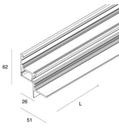
**Spécificités:** Profil pour bande LED encastrée qui disparaît dans la plaque de plâtre et crée une ligne lumineuse périphérique. Eclaire les murs de manière uniforme et met en valeur la texture, le revêtement en pierre ou les finitions spéciales.
