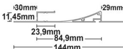
**Spécificités:** IMPORTANT: La surface adhésive doit être dégraissée avant utilisation! Le profilé doit être fixé tous les 40 cm afin d'éviter les risques de dilatation. La LED doit être collée sur une surface dégraissée délicatement sans être pliée. Le collage du ruban s'effectue toujours hors tension. Masse frigorifique = 990 grammes/mètre, Conçu pour les bandes flexibles LED d'une largeur maximale de 11 mm.
