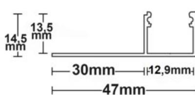
**Spécificités:** IMPORTANT: La surface adhésive doit être dégraissée avant utilisation! Le profilé doit être fixé tous les 40 cm afin d'éviter les risques de dilatation. La LED doit être collée sur une surface dégraissée délicatement sans être pliée. Le collage du ruban s'effectue toujours hors tension. Masse frigorifique = 237 grammes/mètre, Conçu pour les bandes flexibles LED d'une largeur maximale de 14 mm.
