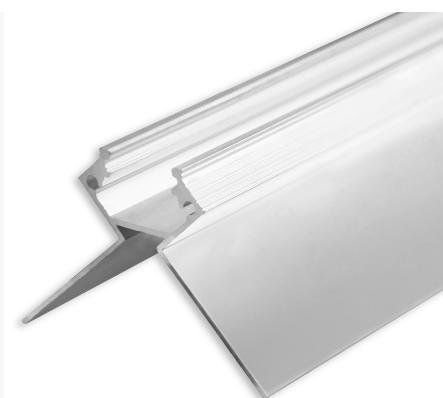
**Spécificités:** IMPORTANT: La surface adhésive doit être dégraissée avant utilisation! Le profilé doit être fixé tous les 40 cm afin d'éviter les risques de dilatation. La LED doit être collée sur une surface dégraissée délicatement sans être pliée. Le collage du ruban s'effectue toujours hors tension. Masse frigorifique = 344 grammes/mètre, Conçu pour les bandes flexibles LED d'une largeur maximale de 12 mm.
