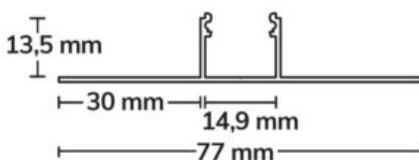
**Spécificités:** IMPORTANT: La surface adhésive doit être dégraissée avant utilisation! Le profilé doit être fixé tous les 40 cm afin d'éviter les risques de dilatation. La LED doit être collée sur une surface dégraissée délicatement sans être pliée. Le collage du ruban s'effectue toujours hors tension. Masse frigorifique = 283 grammes/mètre, Conçu pour les bandes flexibles LED d'une largeur maximale de 14 mm.
