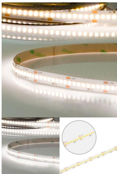
du ruban par alimentation : 2.5m | tolérance de longueur + dilatation thermique : 1% | inclus la bande adhésive 3M 300LSE | nettoyer et dégraisser le support avant de le coller ! Ne Point de séparation décoller à nouveau ! | composé de refroidissement requis : min. 280 gr/m
